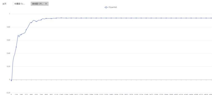
图 3-26 机翼 airfoil 的升力系数随迭代步变化的曲线图
