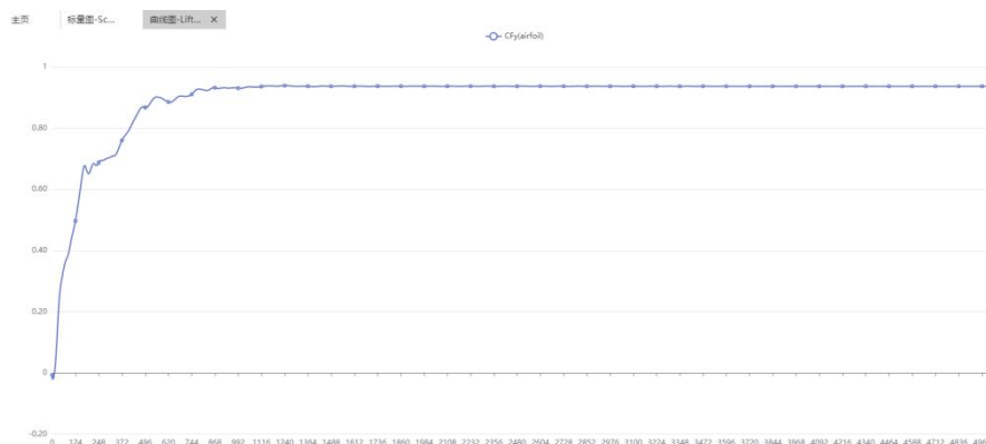
图 2 机翼 airfoil 的升力系数随迭代步变化的曲线图
